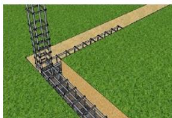
Figura 1. Construcción viga de cimentación.
